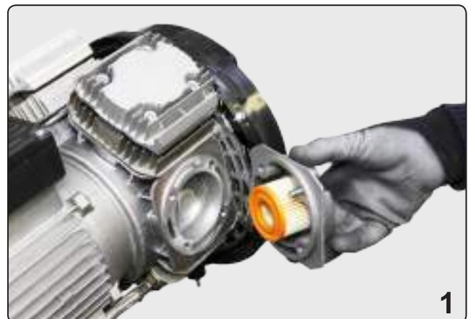
● Se presente il filtro **HEPA14** (Fig. 1) sostituirlo in base a quanto riportato nel Manuale d'Uso dello stesso.
