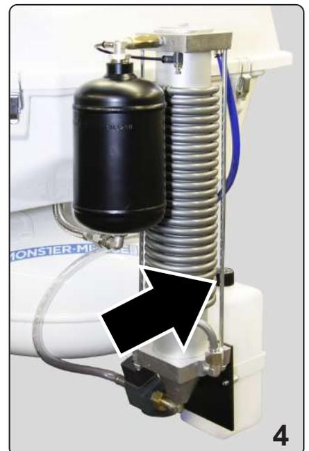
Das Vorhandensein von Kondensat im Tank mindestens alle drei Monate überprüfen, indem das Kondensatablassventil am Tank geöffnet wird (Abb. 1 - 2 - 3).
